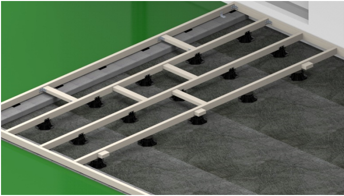
12. Drei kurze Abschnitte der Unterkonstruktion ca. 100 mm lang, werden zuerst flachliegend an den ersten Balken geschraubt. Die Stücke sollten ca. 10 mm tiefer liegen.
