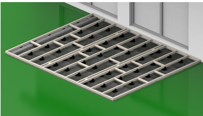
14. Wenn alle Unterkonstruktionen an der Rahmenkonstruktion angeschraubt worden sind, können die Verstellfüße exakt ausgerichtet werden.
