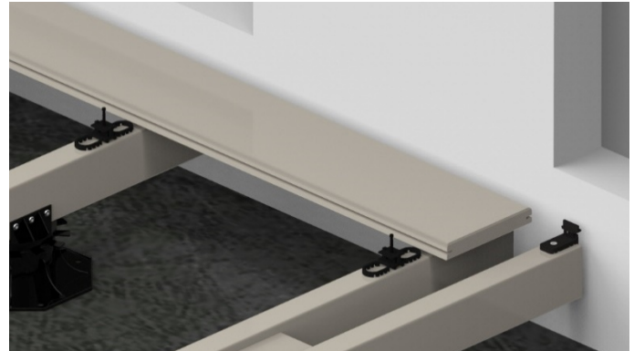
Bild 22. Die Dielenenden sollten an den Längenstößen ca. 30 mm überstehen und an der Rasenkantenseite ca. 10-20 mm.
