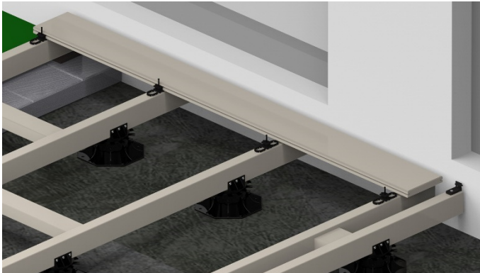
Bild 21. Stecken Sie die erste Terrassendiele auf die Start-Clips und schieben auf der anderen genuteten Seite der Terrassendiele die Kebony RASK-Clipse unter die Diele.
