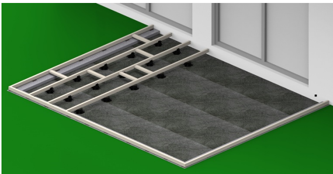
Bild 8. Mit kurzen Querhölzer wird eine ausgesteifte Rahmenkonstruktion erstellt.
