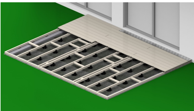
Bild 31. Verlegen Sie die weiteren Terrassendielen auf der gesamten Fläche nach den vorherigen Schritten und prüfen Sie zwischendurch ob die Abstände zur Hauswand gleich sind. Ggf. muss nachkorrigiert werden, damit die vordere Diele gleichmäßig breit geschnitten werden kann.
