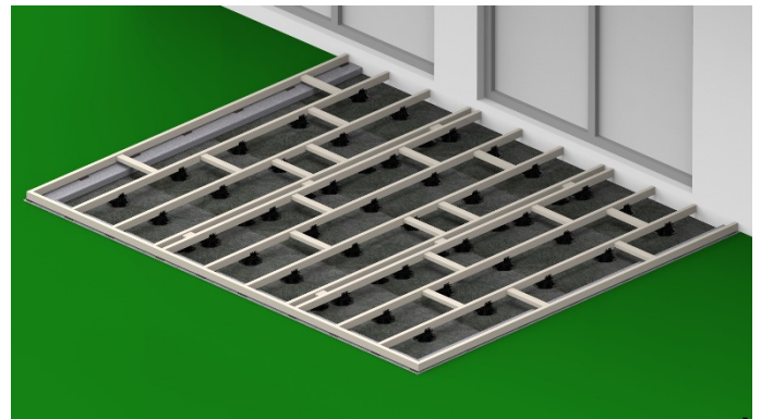
Bild 13. Wenn alle Unterkonstruktionen und Verstellfüße montiert sind, kann die komplette Rahmenkonstruktion ausgerichtet werden.
